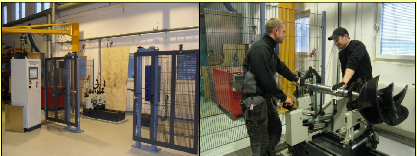
Balanseringsmaskinen i sin helhet med det datoriserade styrsystemet.
